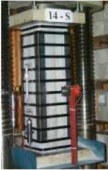
Figura 1: Disposizione base con angolari continui (campione di una prova sperimentale).
